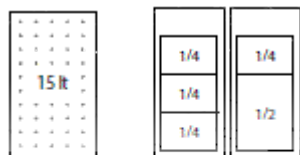
Schema bacinelle misure G/N su modulo da 30 cm
