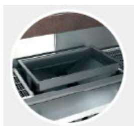
**La piastra è sostenuta da un telaio di struttura con deflettori** che hanno il compito di raccogliere la cenere e spostarla nel sottostante cassetto di raccolta. Il telaio è estraibile per consentire la sua pulizia e l'accesso alla parte sottostante. Mediante delle leve esso è regolabile in altezza.
