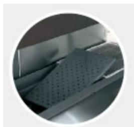
**Ogni pozzetto è costituito da una piastra forata in acciaio termico**, per sostenere le braci e mantenere il calore, risparmiando combustibile. I fori lasciano cadere la cenere combusta verso il basso ed il piano è estraibile per consentirne la pulizia e l'accesso comodo alla parte inferiore.
