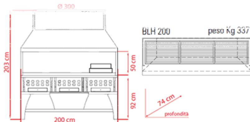
SBA20 sistema a barriera d'aria (lama d'aria)
