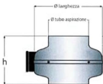
Aspiratore elettrico per cappe. Cassonetto esterno arrotondato da installare sopra la cappa. Portata max 325 m<sup>3</sup>/h
